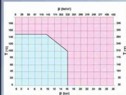
حد مجاز دما و فشار سرویس عبوری آن شیر
